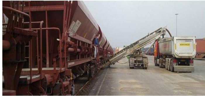
Figure 3 : déchargement de granulats dans un Railport en Allemagne (source : DB-Schenker)
